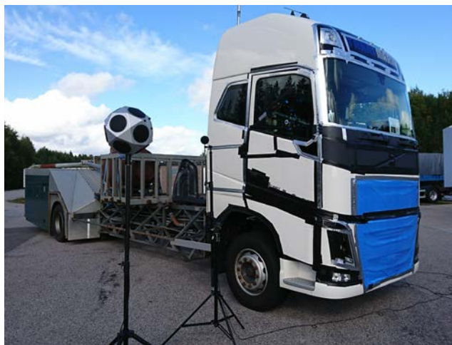
Figur 2. Provobjektet (här utan spegel monterad). Drivlinan är i bak på fordonet. Hytten är tejpad för att undvika övriga vindbruskällor förutom speglarna. Vindmätaren sitter på stången som sticker upp från hytten. Högtalaren används här för att testa ljudreduktion genom dörren (inte del av standardtestet).
