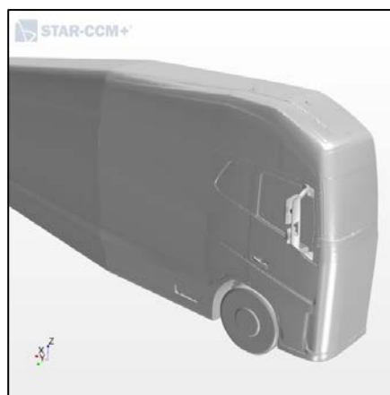
Figur 7. Förenklad lastbilsmodell för simuleringar.
