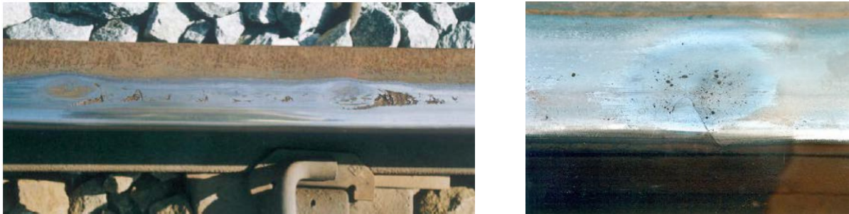
Abbildung 1: Beispiele für Schienenfehler auf der Fahrfläche: Schleuderstelle (links) und Squat (rechts) [1]
