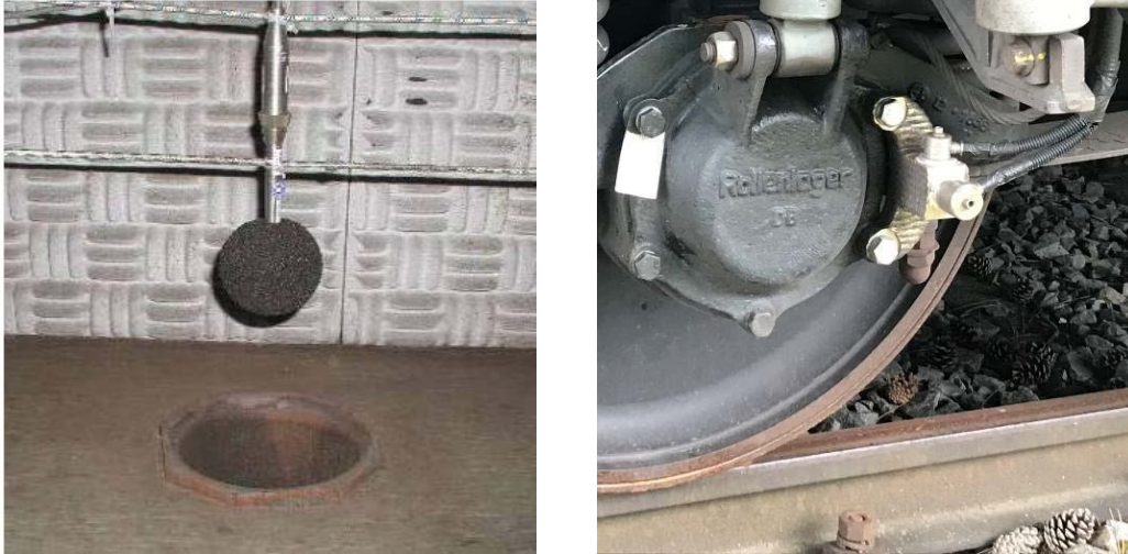
Abbildung 5: Messaufnehmer am Schallmesswagen der DB Systemtechnik: Mikrofon in Messkabine über dem Messdrehgestell (links) und Beschleunigungsaufnehmer am Achslagergehäuse (rechts) (Fotos: DB Systemtechnik GmbH)
