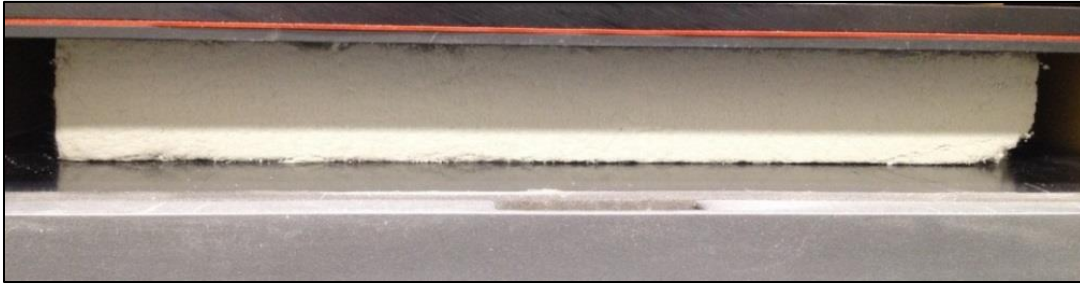
Figure 12: Rigid APM board installed in the heat flow meter apparatus without insulation at the edge. Source: Deutsches Zentrum für Luft- und Raumfahrt.
