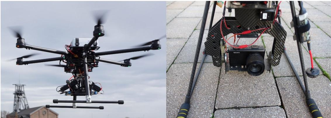
Abb. 3: Hexapilots HP-TS960 (links) und für die Aufnahmen eingesetzter Kameragimbal (rechts) zur Orientierung der Kamera auf das Messobjekt
