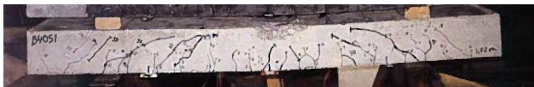
(a) Balk efter kvasi-statisk belastning till böjbrott
