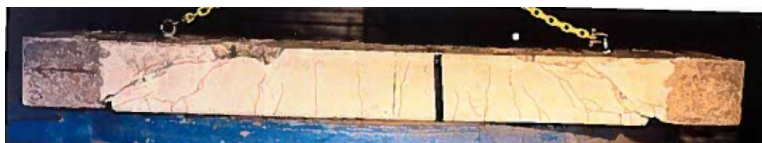
(b) Identisk balk efter belastning med luftstötståg till skjuvbrott
