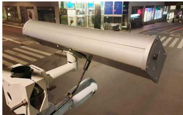
Multifunktionssensor med kamera som registrerar och räknar all typ av fordonstrafik - bilar, bussar, motorcyklar och cyklar. St Eriksgatan, Stockholm.
