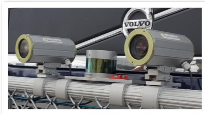
Figur 36. Kamerasystemet monterat på dragbilen (Combitech).
