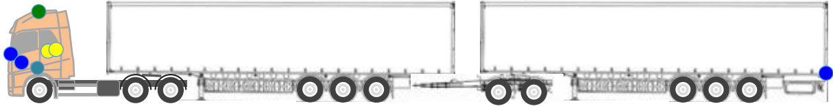
Figur 65. Logistikplattformen. En A-dubbel bestående av dragbil, semitrailer, dolly och semitrailer. De färgade cirklarna illustrerar sensorer som monterades på fordonet.
