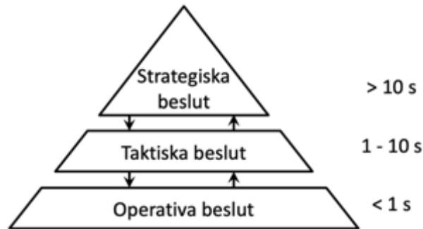
Figur 6. Strategisk, taktisk och operativ nivå för beslut vid autonom körning (beslutshorisont i sekunder) (Hoel, 2021).
