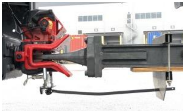
Figur 52. Vinkelsensor monterad under VBG-drag på semitrailer till dragstång på dolly.
