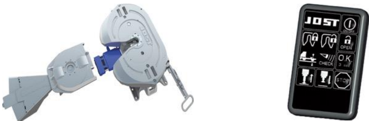
Figur 57. Trailerenhet med kingpin samt vändskiva för KKS-systemet (till vänster). Den blå delen är kontaktdonet för el och luftförsörjning till trailern. Kontrollpanelen i hytten (till höger). (bild från JOST).
