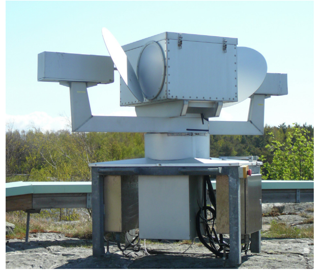
Fig. 4. The water vapour radiometer (WVR) Konrad.
