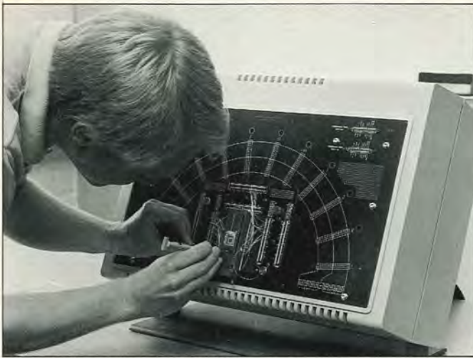
Tillverkade och kapslade VLSI-kretsar verifieras av teknologerna i en avancerad mätutrustning.
