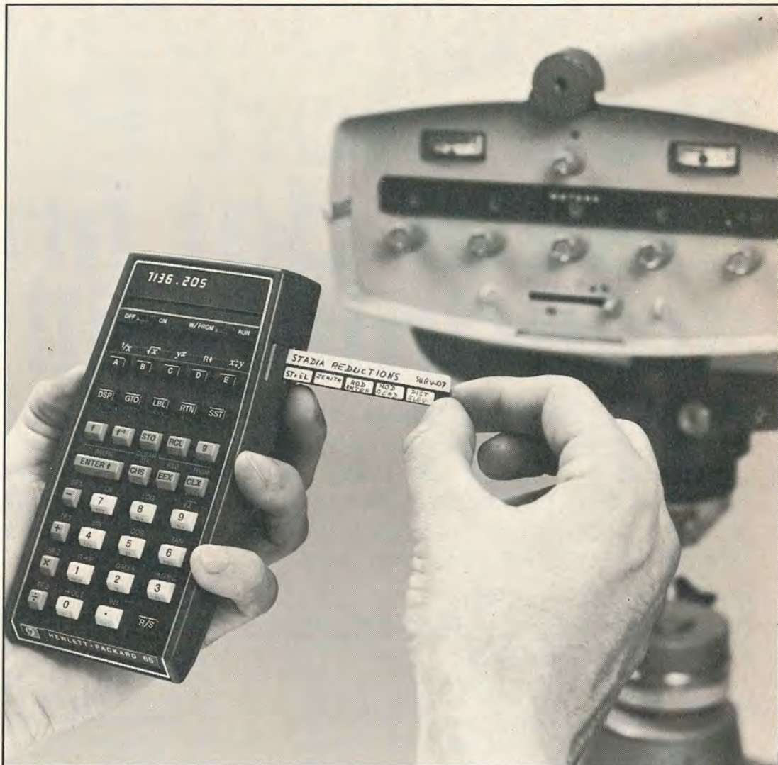
Programmerbara räknedosor har hittills varit utrustade med magnetkort för olika program (bilden). Nu kommer programmerbara räknedosor med s k icke-flyktiga halvledarminnen som till och med kan vara hopbyggda med logikkretsarna i samma kapsel.
