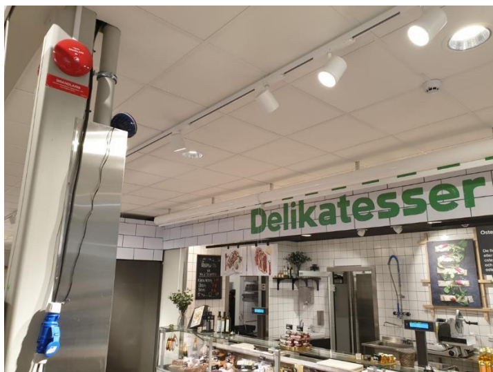
Figur 4 Loggning av koldioxid, temperatur och relativ fuktighet i delikatess-zonen under mätperiod 1.
