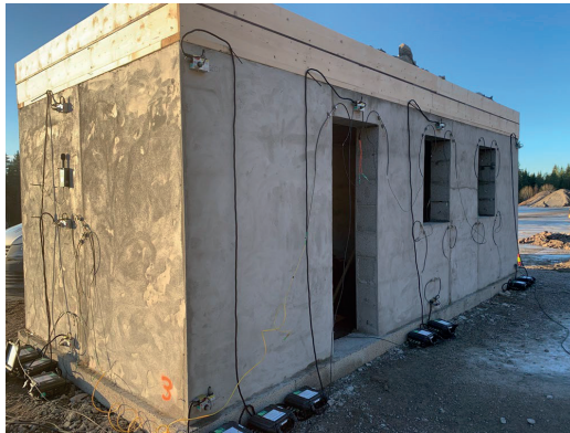
Figur 2.3 Foto av byggnad i försöksserie 2 med instrumentering. Från Remedy (2021). Photo of building in test series 2 with instrumentation. From Remedy (2021).
