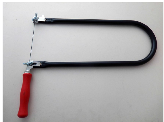
Fig. 2 A fret saw. Image: Gerd Fahrenhorst
