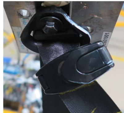
Figur 19. Placering av bältesstoppare med 30 mm slack.
