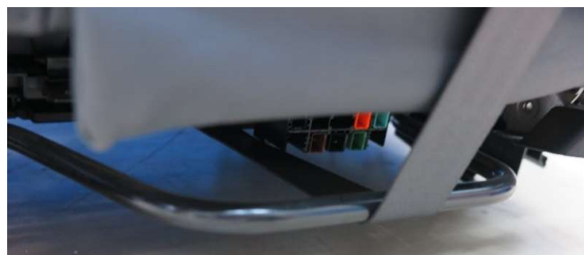
Figur 7. Risk att stolens låsning i skenan lossnar vid en ev bälteförsträckning om bältet av misstag lagts runt spärrhandtaget.
