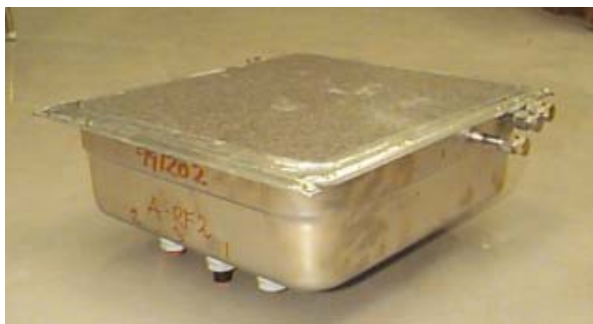
Figur 15 Golvsystem vid långtidsförsök för mätning av alkalisk hydrolys av golvsystem.
