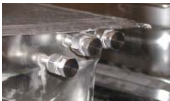
Figur 5 Mätörerna för VOC-profiler försluts med Swagelok-kopplingar i båda ändarna mellan mättillfällena.
