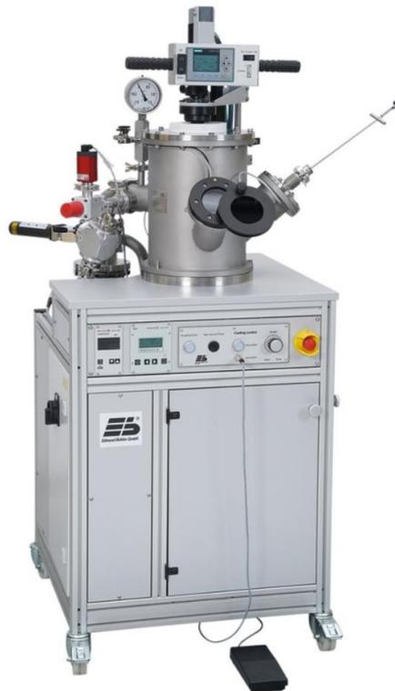
Figure 4.1. Arc melter from Edmund Bühler GmbH
