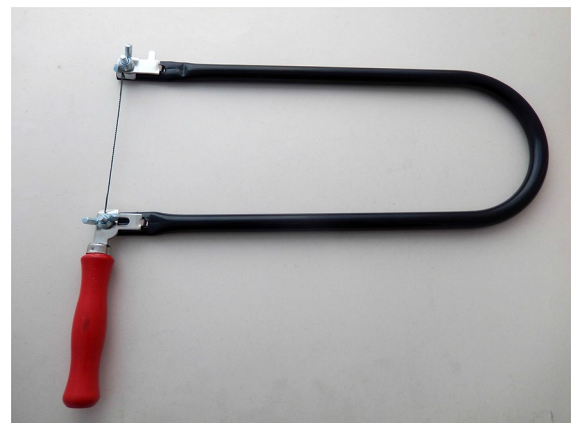
Fig. 2 A fret saw. Image: Gerd Fahrenhorst
