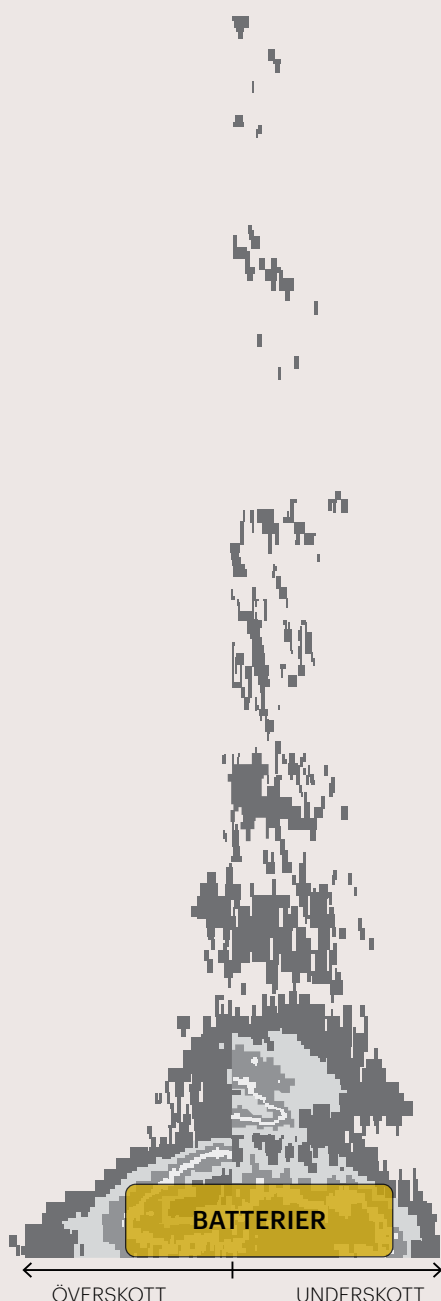
FIGUR 10: Batterier är lämpliga för att möta flexibilitetsbehov som uppstår ofta men och med kort uthållighet.
