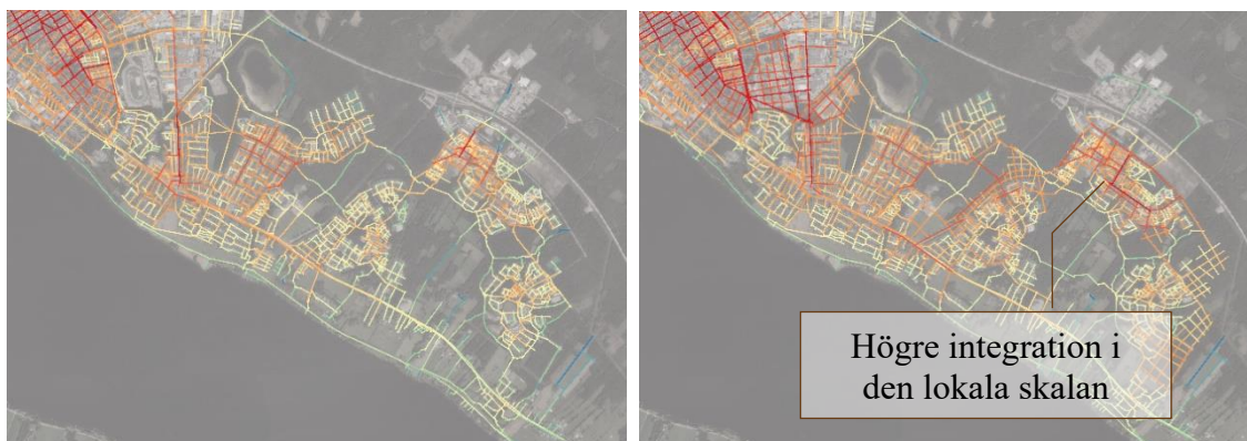
Figur 3. Integration (closeness centrality) inom en radie av 6 steg/riktningsförändringar (r6), nuläge (vänster) och framtidsbild 2050 (höger). Resultat av integrationsanalys visualiserar i färgskala från grön/blå för låga värden och gul/röd för höga värden. Detta kombineras i visualiseringen med ett flygfoto som bakgrund.
