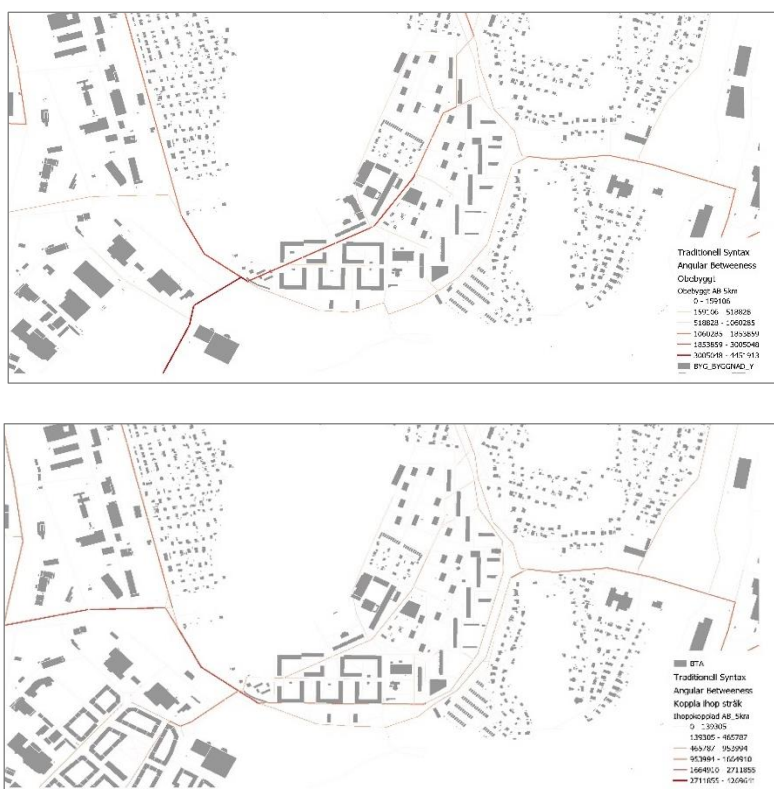
Figur 6. Genhetsanalys (betweenness centrality) inom 5 kilometer: scenario 1 (övre bild) och scenario 2 (nedre bild). Resultat av genhetsanalys visualiserar i färgskala från tjockare mörkare röda linjer i röd för höga värden till tunnare linjer för låga värden. Detta kombineras med en bakgrundsbild med byggnader.
