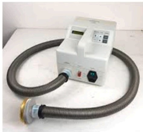
Fig. 1. Air sampler Sartorius MD8 (Sartorius AG).
