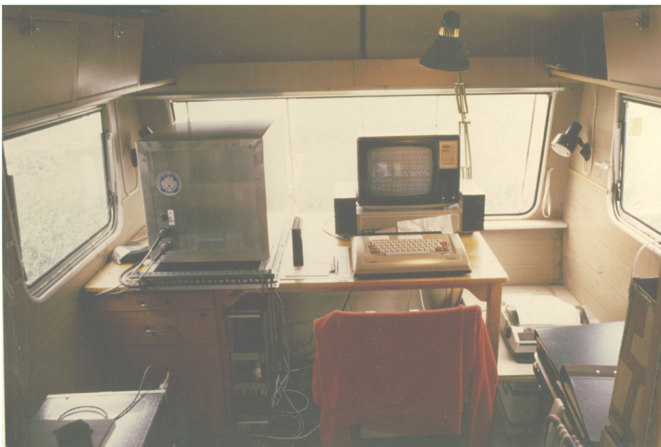
Insidan av husvagnen med ABC 80 för styrning och mätdatalagring av radiometrarna
